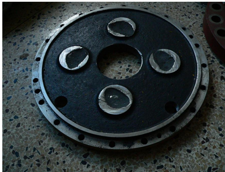
减速器行星架断裂
